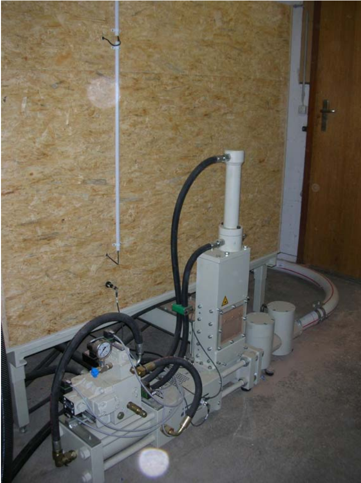
Presseinheit mit 2 Zangenzylinder und auswechselbarem Pressgehäuse
